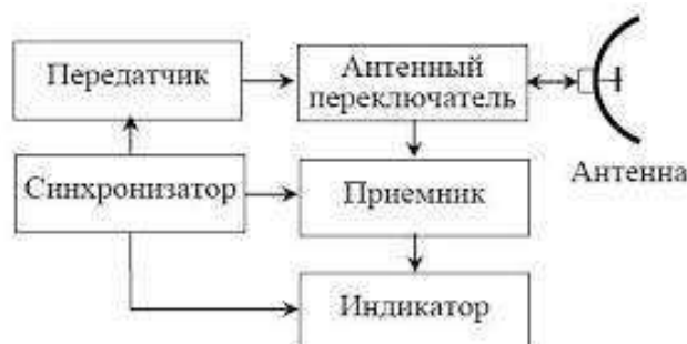
Рис. 1. Основные блоки радиолокационной системы
