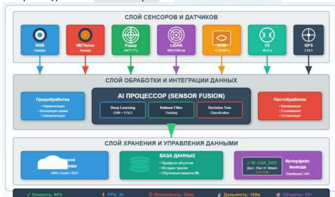
Рис. 4. Структура визуально-радиотехнической гибридной системы
