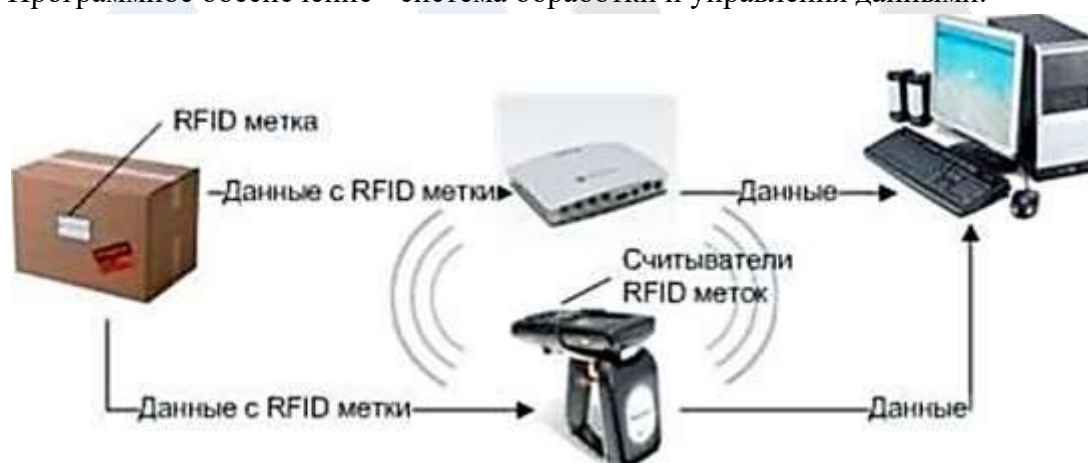
Рис. 2. Принцип работы RFID-системы
