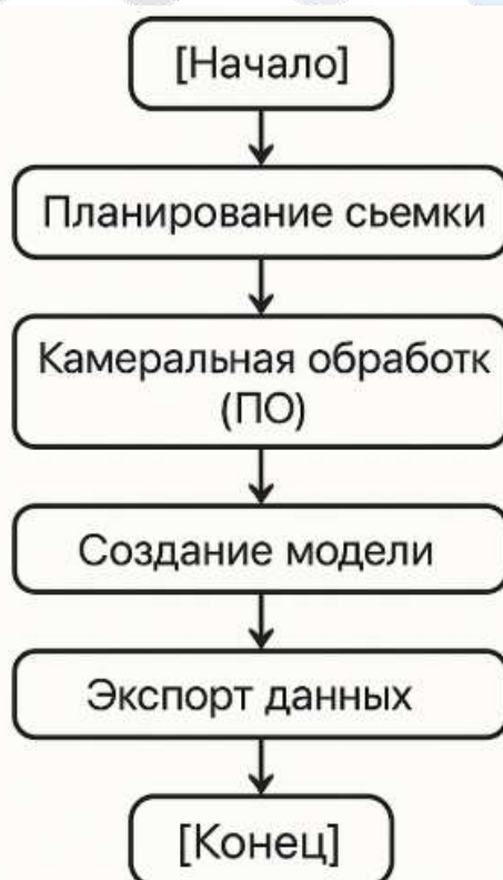
Рис 1. Рабочий процесс фотограмметрии (SfM)
