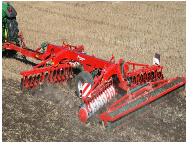
5-rasm. Kverneland Visio diskli boronasi (Fransiya)
